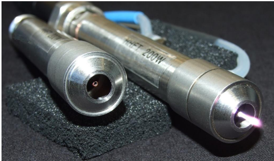
Abb. 4: Frontansicht zweier Plasmajets der PC-B-Klasse mit Argon als Prozessgas bei 0,1 sl/min und Luft zur weiteren Kühlung.
