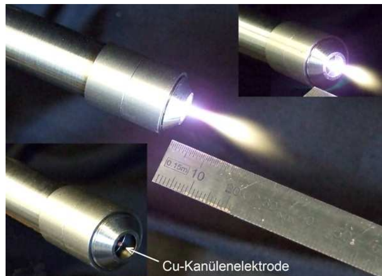
Bild 8.19: HHF-Plasmastrahler der PC-Serie mit Kanüle
