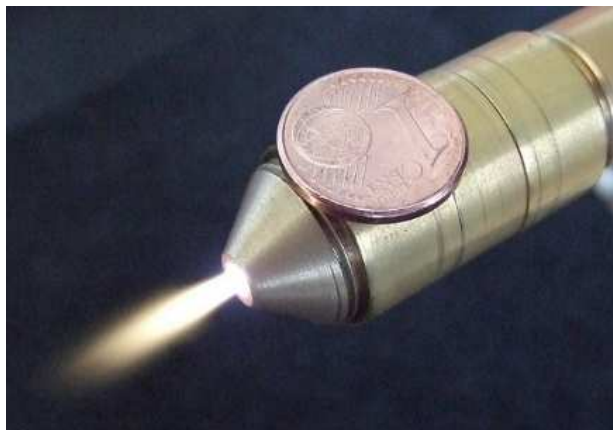
Bild 8.18: Vielfältig einsetzbarer Plasmastrahler (hier Prozessgas: Luft, 100 W und breite Öffnung)
