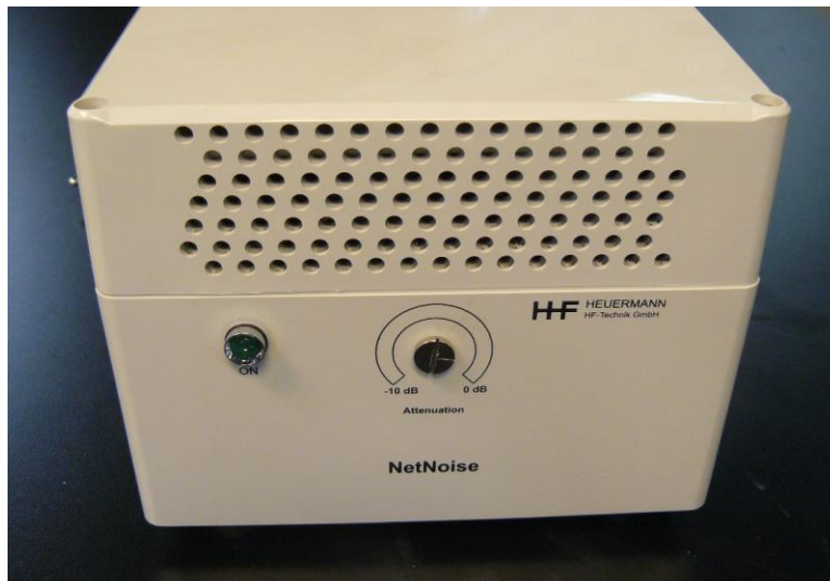
Frontansicht des Netz-Rausch-Generators netNoise 40-220
