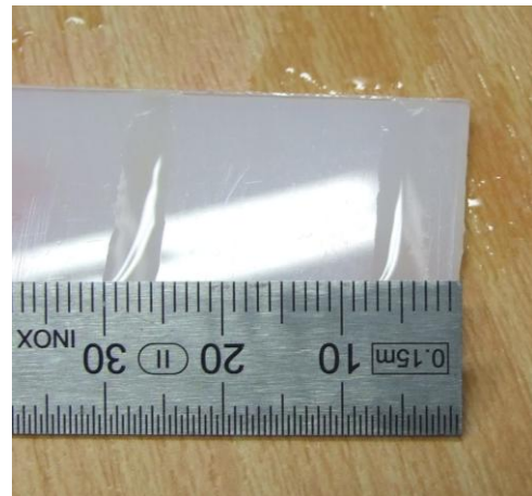
Bild 8: Aktivierung einer Folie mit Luft als Prozessgas, getestet mit Wasser
